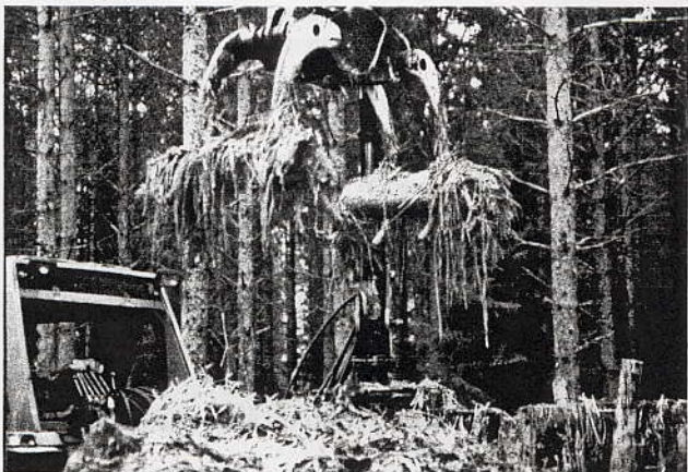
Oljen ja savilietteen sekoitusta puutavara-kuormaajan kouralla johon oli hitsattu lisäpiikit.
