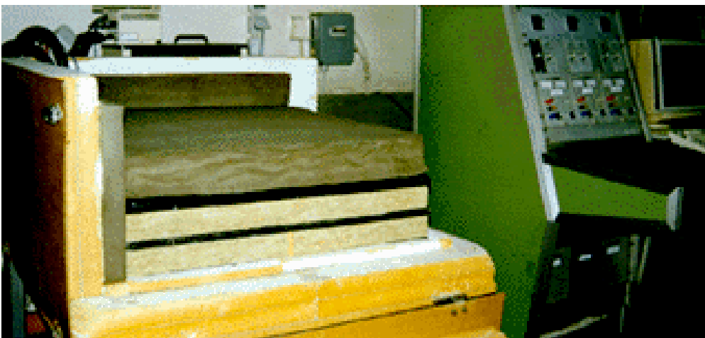
Lämmönjohtavuuden koelaitte ÖNORM B 6015 -kokeseen http://www.tgm.ac.at/va/vaws/ws.htm/
